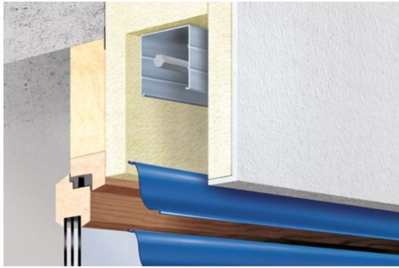
Horizontalschnitt für Gelenkkurbel-antrieb
