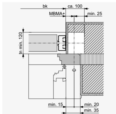
Vertikalschnitt: Beispiel Abdeckung
