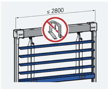
Die selbsttragende Storenkonstruktion schont die Isolation im Sturz und reduziert Servicekosten. Bis zu einer Breite von 2800 mm kommt das System ohne Befestigung für den Tragkanal aus – die Isolation bleibt intakt und die Geräuschübertragung wird reduziert.
