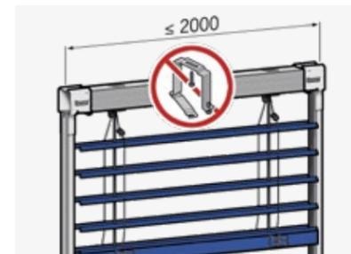
Die selbsttragende Storenkonstruktion schont die Isolation im Sturz und reduziert Servicekosten. Bis zu einer Breite von 2000 mm kommt das System ohne Befestigung für den Tragkanal aus – die Isolation bleibt intakt und die Geräuschübertragung wird reduziert.
